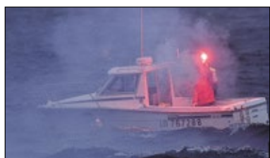
Bengala de mano, indicada sobre todo para dispararse de noche y ser detectado a cortas y medias distancias
