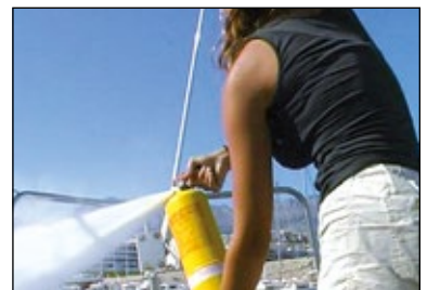
Extintor de polvo seco
